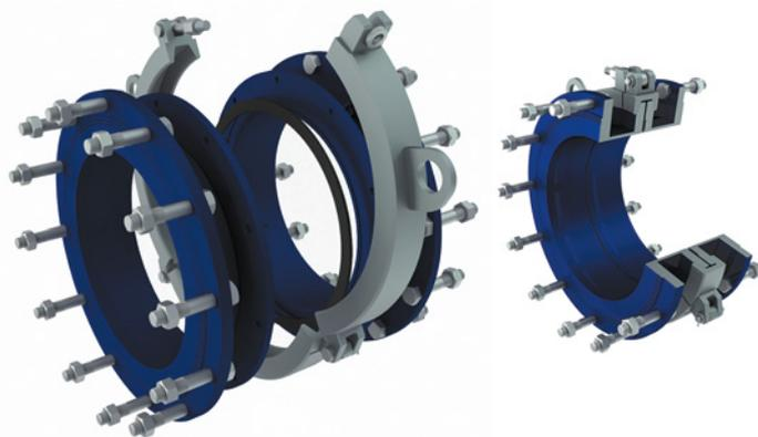
Быстроразъемное соединение (БРС) представляет собой деталь, состоящую из трех элементов, позволяющую произвести как быстрый монтаж секций трубопровода, так и их экстренное разъединение.
